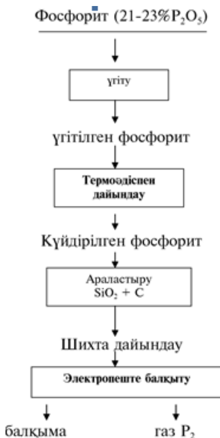
3.1-сурет. Сары фосфор өндірісінің принципіалды сұлбасы
